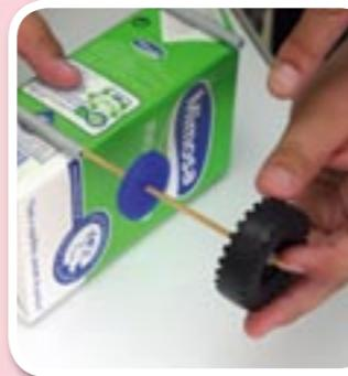
**4** Recorta um pequeno círculo de cortiça com um diâmetro de 8 milímetros e faz um rasgo lateral adequado à espessura do elástico (polie pequena). Fixa-a ao veio do motor. Coloca o elástico na polie grande e na polie pequena, afastando o motor de forma a consegires uma certa tensão no elástico. Com uma caneta marca um círculo que indica a posição do motor no pacote.
